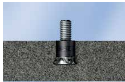
Dettaglio: sottosquadro nella lastra
